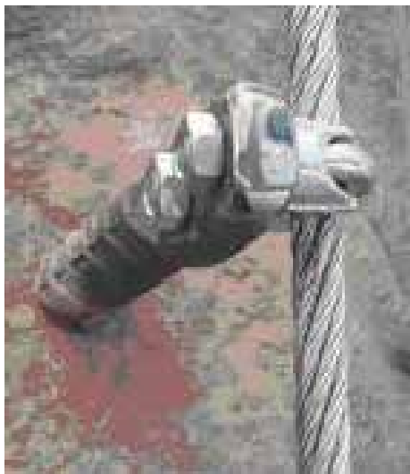
Slika 34: Masivno ploščato-kovano sidro, namenjeno prečnim obremenitvam.
