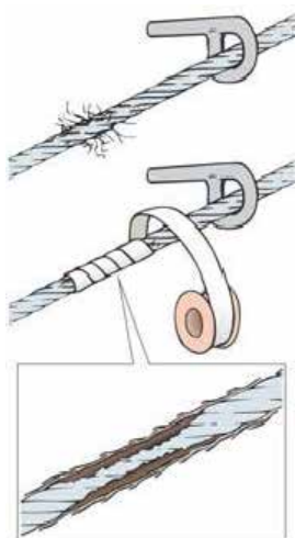
Slika 24: Povijanje jeklene vrvi s trakom daljnoročno pripelje do njene notranje korozije.
