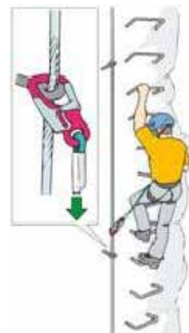
Slika 10: Vponka na očesnih sidrih z močno prednapeto jekleno vrvjo
