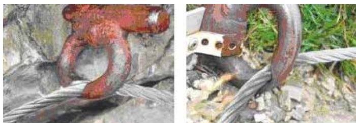
Slika 19: Odbrušena očesa sider
