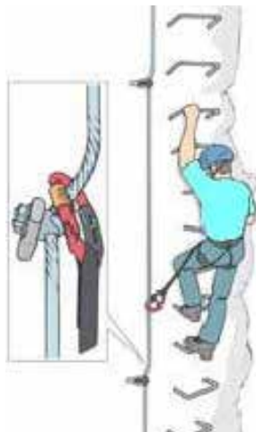
Slika 9: Vponka na stisnjenih sidrih z nenapeto jekleno vrvjo
