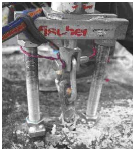
Slika 16: izvlek sidra v njegovi osi s hidravliko
