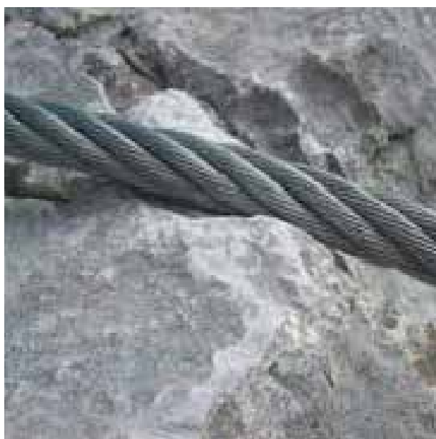
Slika 50: Jeklena vrv se drgne ob skalo in se kmalu poškoduje.
