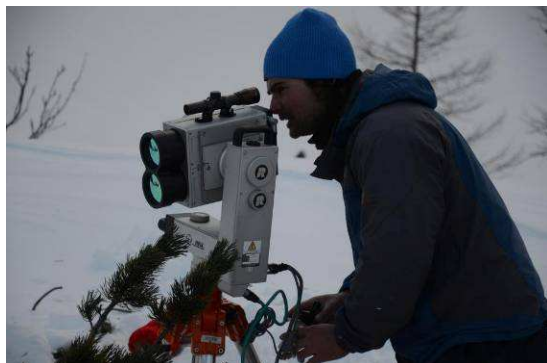
(terestrično lasersko skeniranje na področju Zelenice; tečaj varstva pred snežnimi plazovi-ugotavljanje značilnosti snežne odeje)
